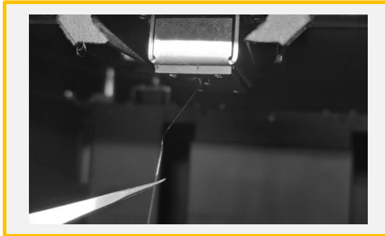
7. 노즐에서 필라멘트의 압출이 완료되면 [완료]를 누른 후에 그림과 같이 핀셋으로 잔여물을 제거 합니다.
