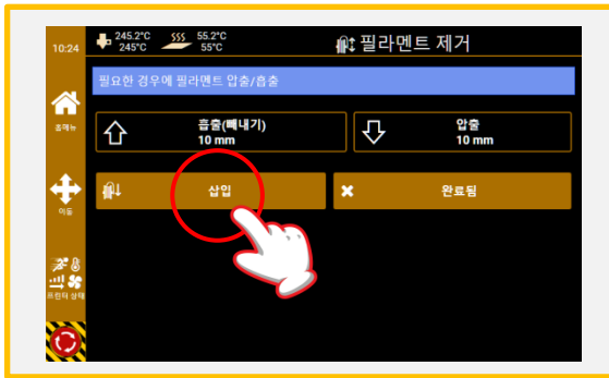
5. 필라멘트를 제거 후, 새로운 필라멘트를 장착합니다. 장착이 완료되었다면, [삽입]을 클릭합니다. *필라멘트 제거 및 삽입 파트 참조
