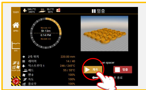
9. [계속] 버튼을 선택하여 출력을 재개합니다. 출력 시작 전 교체 도중 나온 필라멘트를 핀셋으로 제거합니다.
