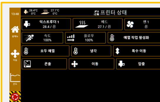
5. [익스트루더 1]을 선택하고 우측에 기재된 소재에 맞게 온도를 입력 합니다. 온도가 올라간 후에 Start 버튼을 실행하지 말고 10분간 대기 합니다.
