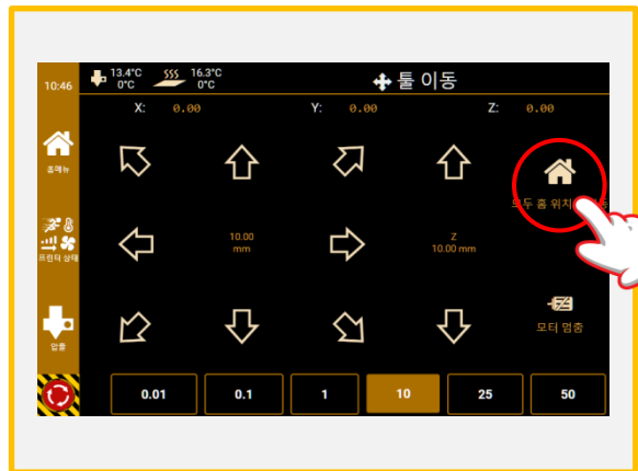
7. 그림과 같이 [모두 홈 위치로 이동]을 눌러 베드플레이트를 상단으로 이동시킵니다.
