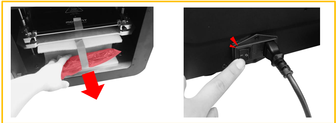
4. 도어를 열어 유리를 고정하는 테이프를 제거 및 파워케이블을 꺼낸 후, 콘센트를 꽂고 전원 스위치를 ON에 놓습니다.
