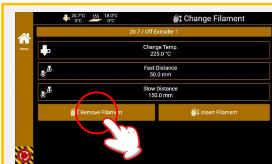
(5) Change Temp : 使用フィラメント温度 Fast Distance : 50mm Slow Distance : 0mm 上記のように設定値を変更した後、 「Insert Filament」を押します。 温度が上がった後、「Start」を押さずに 10分間待機します。
