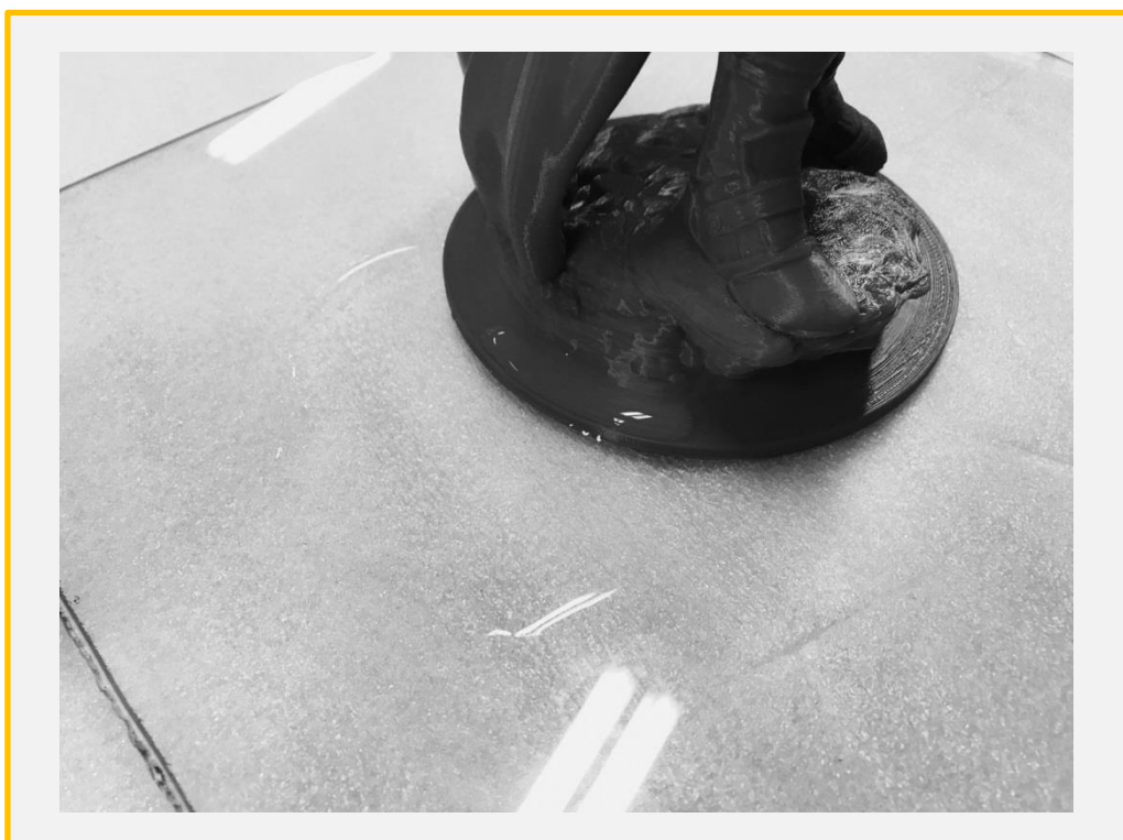
③ 造形物の周囲に少量の水をかけ、1~2分待ってからスクレーパーで取り外します。
