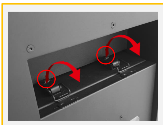
9. プリンターの右面にある、フィラメントボックスの図のロックを引いて、ロックを解除し、ドアを開けます。
